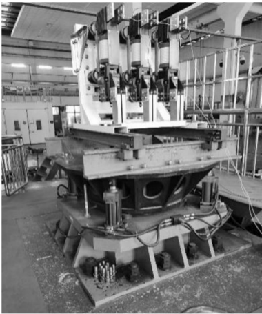
图9 断路器冲击试验台
